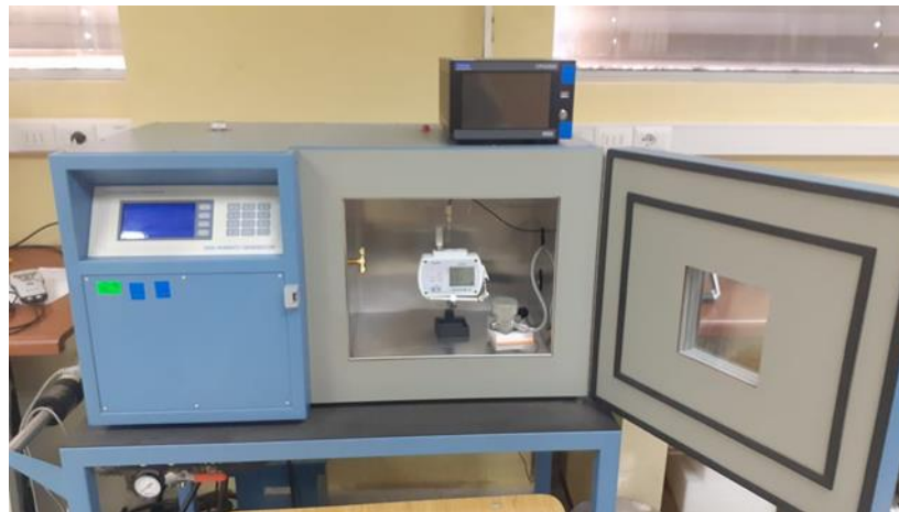
Figura 3. Montaje para la calibración del patrón viajero.
